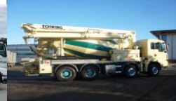
Pumpemikser (2 stk) 24 meter
