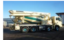
Pumpemikser (2 stk) 24 meter
