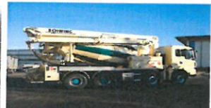
Pumpemikser (2 stk) 24 meter
